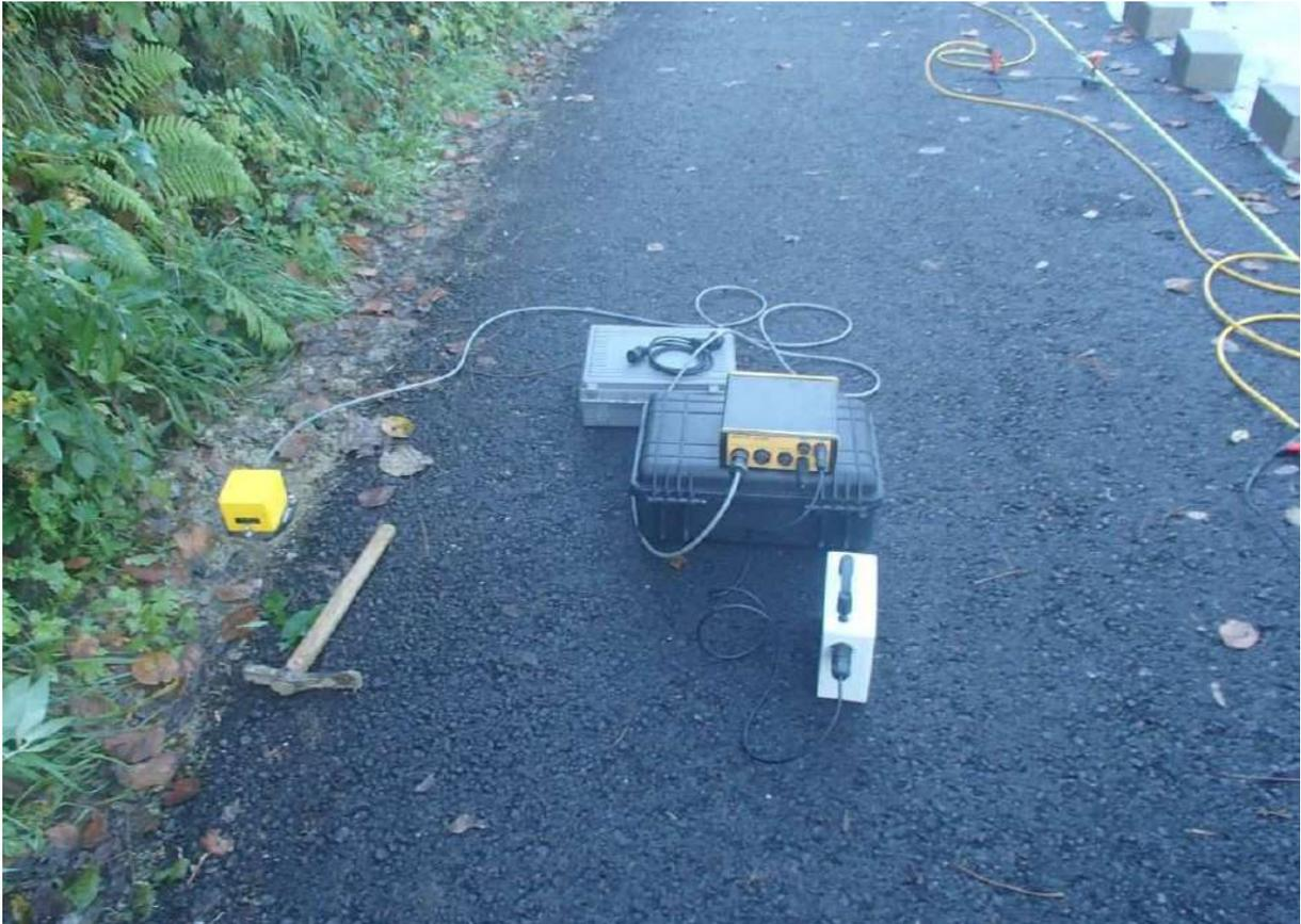
fig. 39 – strumentazione utilizzata per l'indagine H/V con sensore Veloget, acquisitore Dymas
