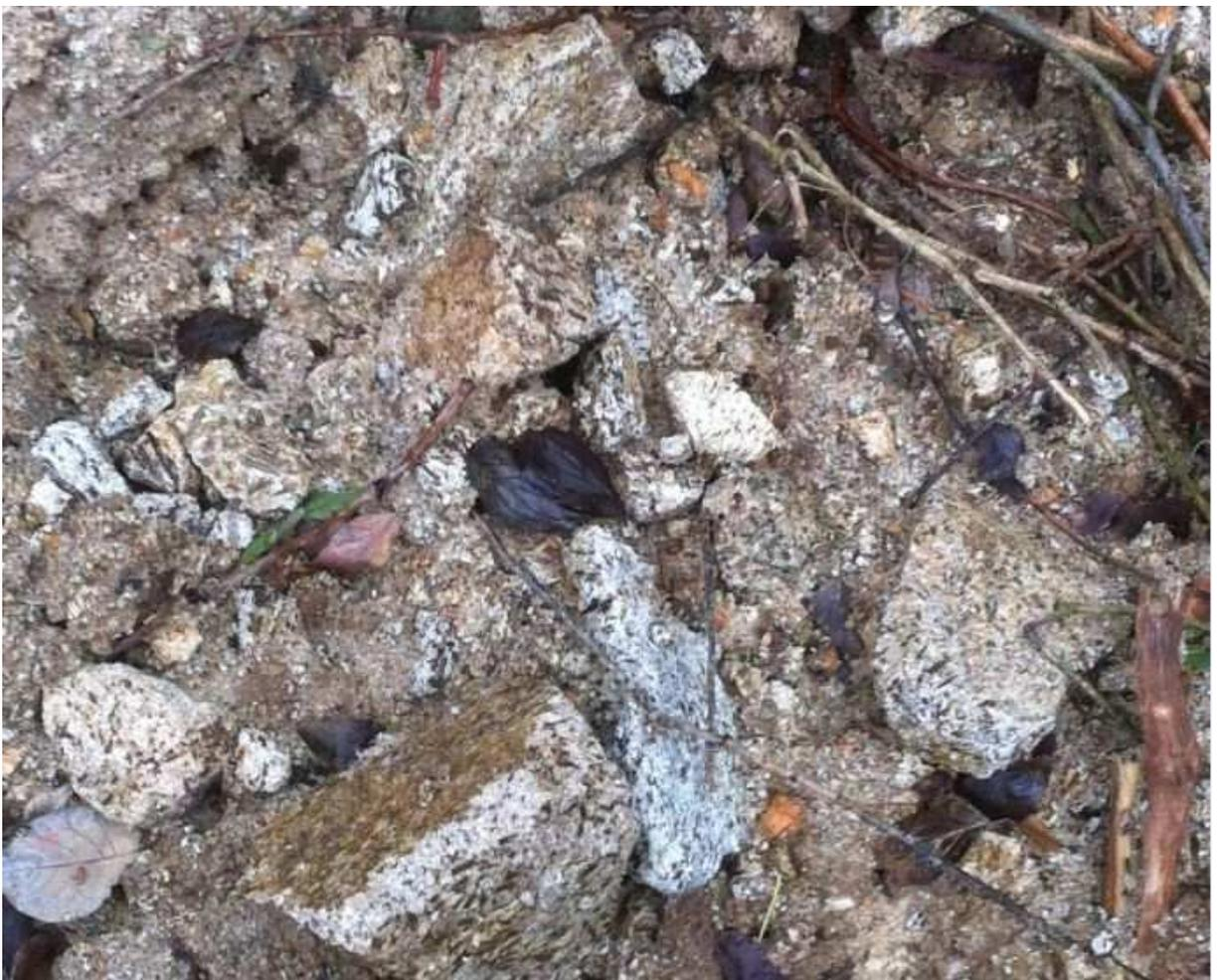
*figg. 28/29 – accumulo detritico al piede del versante, coltri limo-sabbiose e blocchi di porfirite*
