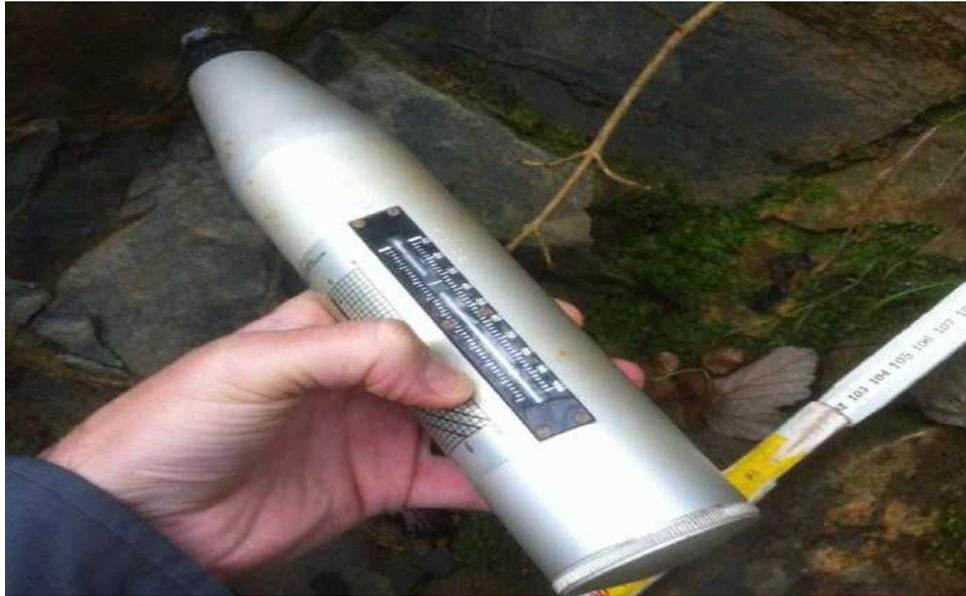
*fig. 18 – misure con sclerometro*
