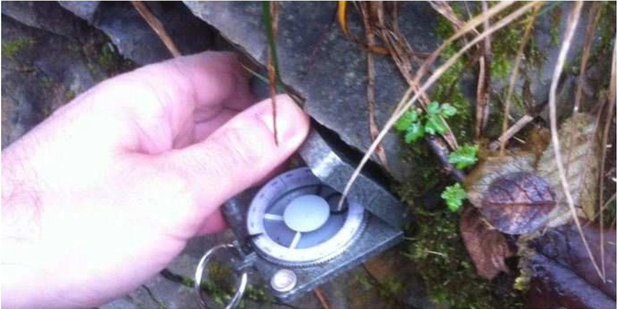
*fig. 20 – rilievo giacitura degli ammassi rocciosi con bussola*
