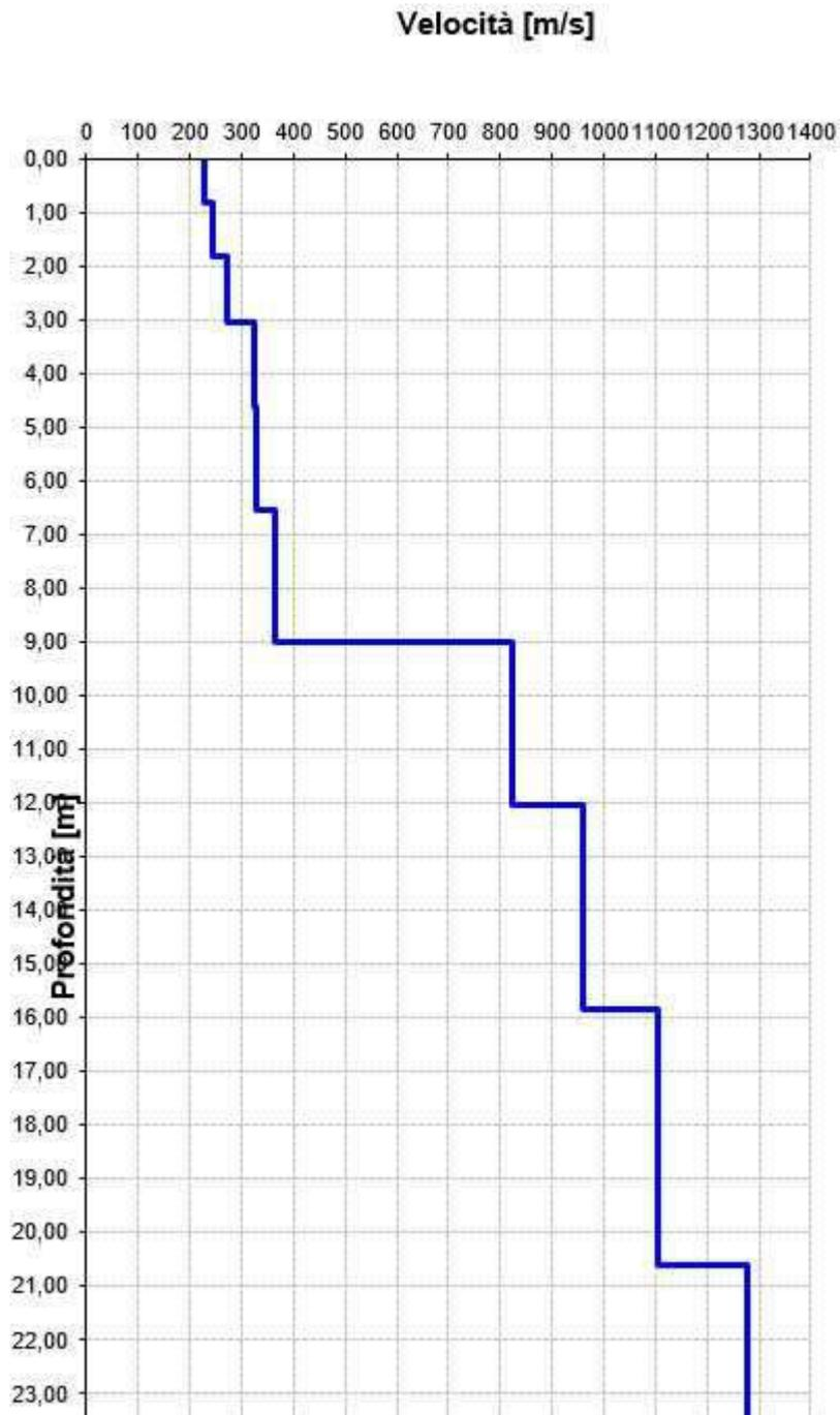
fig. 35 - Profili di velocità delle onde di taglio ( $V_s$ )
